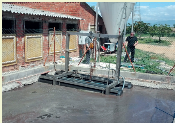
Figura 1. Estructura amb flotador i guia que sustenta el concentrador dins de la bassa a l'alçada desitjada pel seu funcionament. Font: Cooperativa Agrària Plana de Vic.
