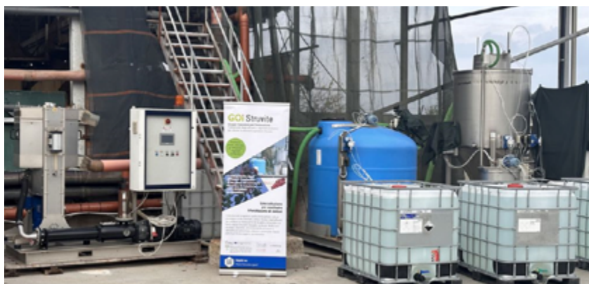
Figura 1 - Il prototipo per il recupero della struvite Figure 1 - The prototype for struvite recovery.
