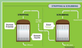
Stripping & Scrubbing voor mestverwerking
