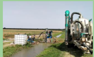
Fertirrigación a partir del digerido microfiltrado a través de goteo en riego enterrado.
