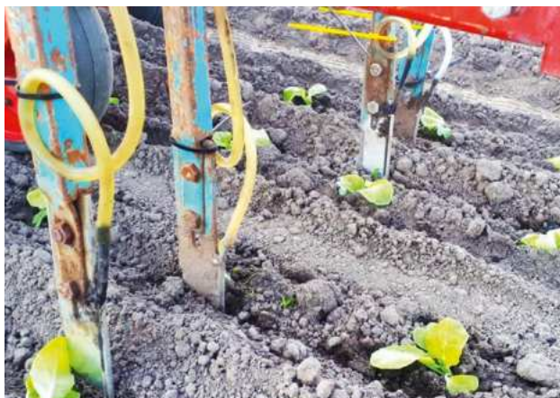
Applicazione di sali di ammonio a colture erbacee e orticole tramite iniezione per ridurre le emissioni di ammoniaca
