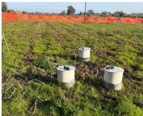
Misurazione in campo delle emissioni di ammoniaca con la tecnica del tunnel a vento (sinistra) e delle emissioni di gas serra con la camera statica (destra)
