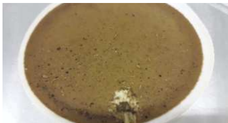
Stadio di raffinazione del precipitato ricco di struvite
