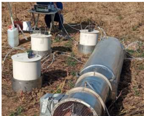
Misurazione in campo delle emissioni di ammoniaca con la tecnica del tunnel a vento (sinistra) e delle emissioni di gas serra con la camera statica (destra)
