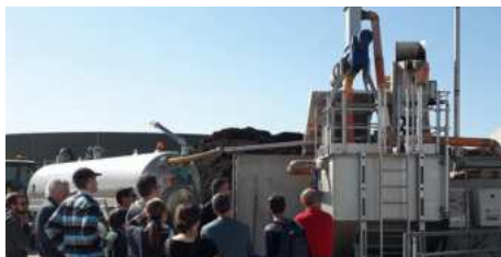
Unità di microfiltrazione del digestato
