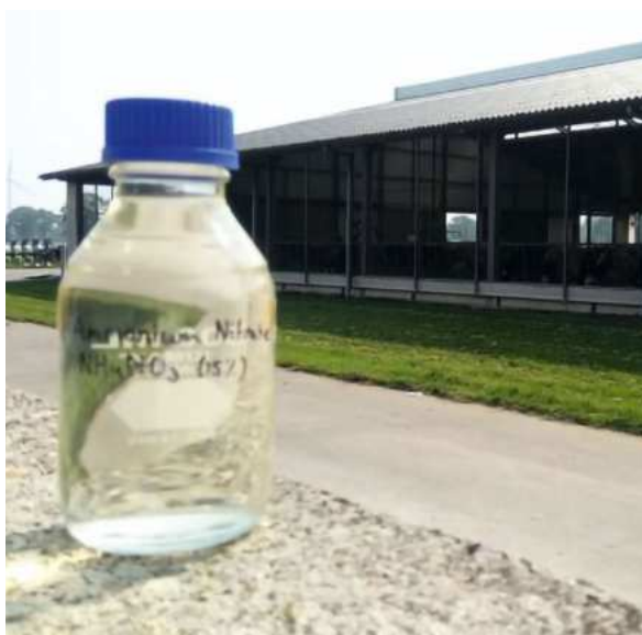
Nitrato di ammonio recuperato dal processo di stripping e scrubbing del liquame
