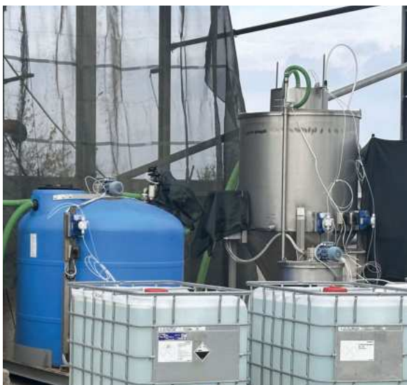
Impianto pilota per il trattamento del digestato e la precipitazione della struvite
