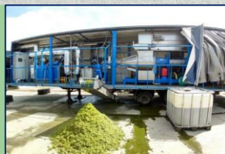
Bioraffinaderi med fast pressekage og flydende præbiotisk/græsvallefraction
